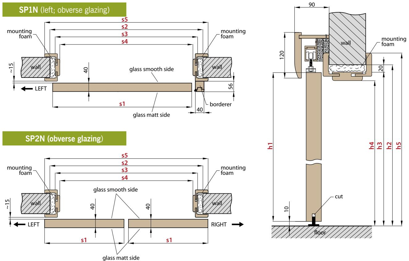
■ ON-WALL SLIDING SYSTEM WITHOUT THE FRAME
